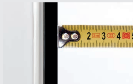
Gummidichtung breiter als 5 mm
